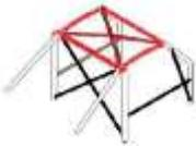
La utilización de las puertas de fibra solamente está autorizada si se presentan instalados paños anti intrusión debidamente conformes a la norma.
